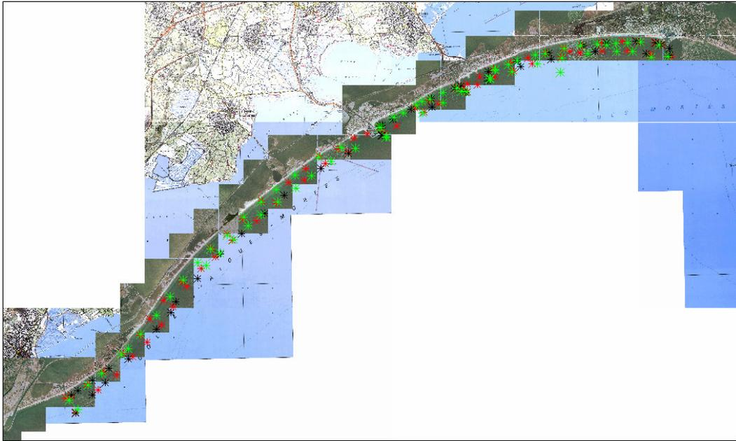
**Figure 5** - Emplacement des points de mesures de la turbidité par la méthode du disque de Secchi
