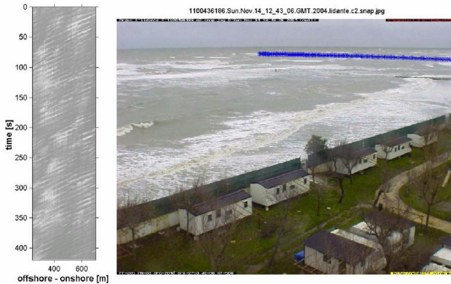
**Figure 26** - Exemple de *time-stack* relatif à un lanceur de pixel perpendiculairement disposé au bord représentable sur l'image de Littoral de Dante le 14 novembre 2004 heures 14.12 (Archetti et al, 2004)
