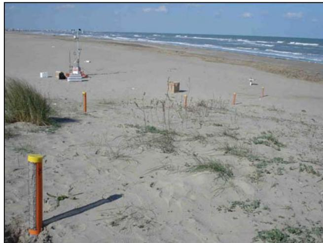
Figure 35 - Disposition des pièges le long des sections d'échantillonnage; en arrière plan on note la station anémométrique avec les différents capteurs de vitesse et de direction du vent.
