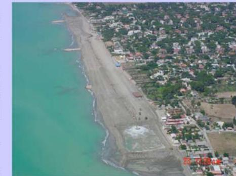
Travaux de rechargement des plages du Latium avec matériaux extraits à 100m de profondeur.
