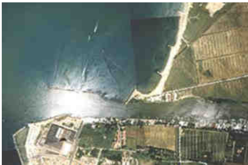
Foto 3 - L'evidente arretramento della riva destra del Fiume Arno rispetto a quella di sinistra (ripresa aerea del luglio 2004)
