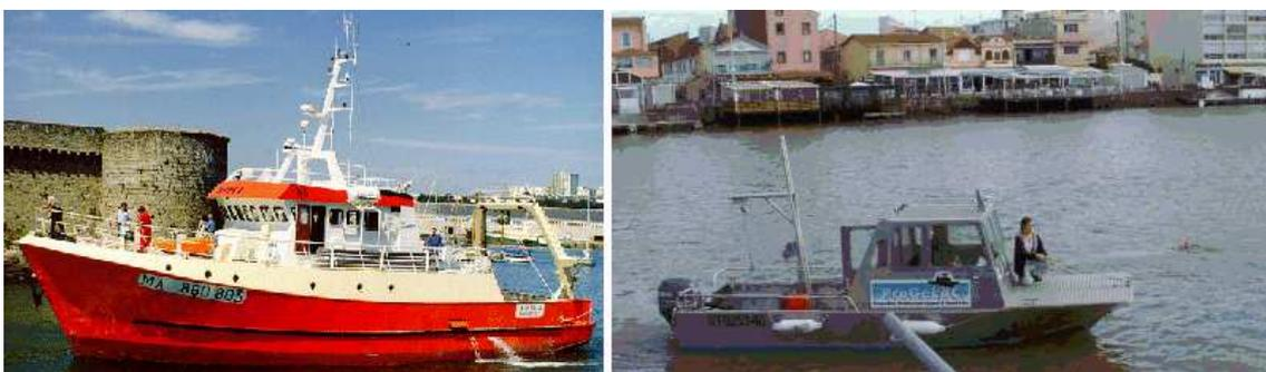
FIG. 2.1 – A gauche : le navire Téthys II de façade de l'INSU. Il dispose d'un ADCP de coque permettant d'obtenir des cartes de la circulation 3D à l'échelle pré-littorale. A droite : le navire PROGELAC. Il permet de déployer les équipements en zone littorale, permet de réaliser des campagnes topobathymétriques.
