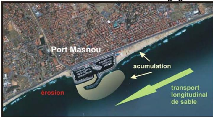
**Figure 3.3.2** - Accumulation et érosion du granulat (Port de Masnou).
