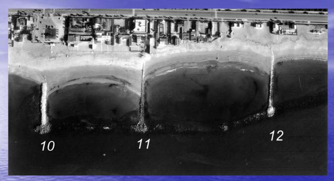
Intervento di manutenzione del pennello 10 e della soffolta posta a levante del pennello 12 reso necessario a causa della forte mareggiata del 14 Maggio 1995 che aveva gravemente danneggiato l'opera che in quelle condizioni non era più in grado di assolvere alla finalità progettuale di difesa costiera.
