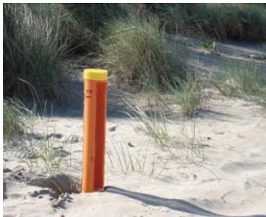
Fig 3.4.3 – Trappola eolica di tipo Rosen modificata (1978).
