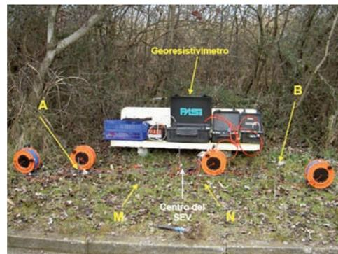
Fig 3.4.4 – Sistema geoelettrico quadripolare «PASI in configurazione Wenner».
