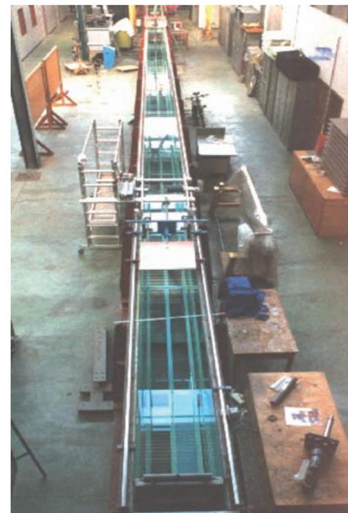
Fig. 3.3.7 – Studi sperimentali nel canale di portata dei sedimenti lungo 36 m con onde irregolari. I test di ripascimento (definiti nella fase B) sui profili di equilibrio delle spiagge ottenuti nel canale d'adduzione sono in via di realizzazione.
