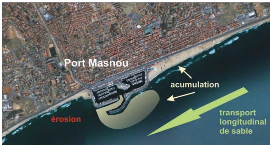
Fig. 3.3.2 - Accumulo ed erosione dei sedimenti (Porto di Masnou).
