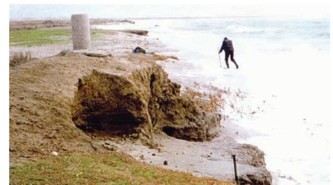
Fig. 3.3.5 - Lo stesso palo topografico della foto della figura 5, 2 Aprile 2000. In questo sito, l'arretramento della riva indotto dall'erosione, è rilevato mediante una serie di misurazioni, è stato registrato intorno a 1 metro all'anno. Due anni fa (2004), il palo topografico è andato perso in mare.
